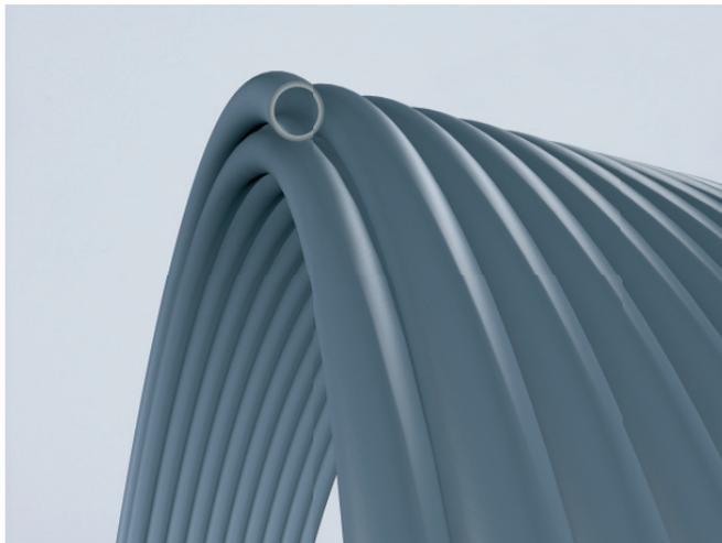
PYD®-THERMOSYSTEME können nicht verstopfen oder verschlammen. Wir verwenden ein diffusionsdichtes, güteüberwachtes PE-RT-Systemrohr der Dimension 20 x 2 mm. Der Einbau einer Systemtrennung ist nicht erforderlich. Die Ablagerung von Kalk ist bei Betriebstemperaturen zwischen 16 und 40° C physikalisch ausgeschlossen. Dies alles gewährleistet die dauerhafte Funktion der
