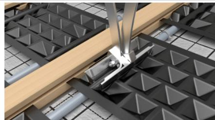
Als Abschluss wird jedes PYD-ALU® Thermoleitblech mit der mitgelieferten Presszange bearbeitet. Dazu wird die Zange mittig und gerade im Bereich der Rohrrille angesetzt und bis zum Anschlag zusammengedrückt. Nur so wird ein optimaler Wärmeübergang gewährleistet.
