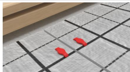
Zur Stabilisierung wird die PYD®-Faltbahn mittels PYD®-Dämmverbindern mit der darunter liegenden Wärmedämmung befestigt.
