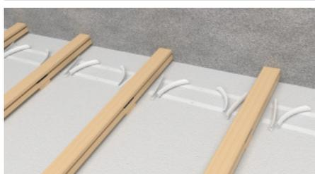
Die PYD®-Montagebögen werden beim VHSP System direkt auf der druckfesten Dämmung am Ende einer jeden Bahn mit 10 cm Abstand zur Wand zwischen den Schwingträgern ausgemittelt.
