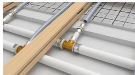
Für den Anschluss am Tichelmannverteiler wird das Rohrende bis zum Anschlag in den entsprechenden Pressverbinder gesteckt, bis es in der Rohrmarkierung zu sehen ist. Die Pressung erfolgt mit einer geeigneten Pressbacke. Bei Verwendung von zertifizierten PYD®-Pressverbindern muss eine Pressbacke mit der Kontur TH verwendet werden.
