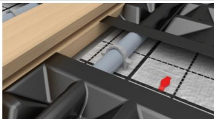
Nach dem Verlegen der PYD-ALU® Thermoleitbleche wird das PYD®-Systemrohr nach jedem zweiten Blech mit PYD®-Systemclips fixiert.
