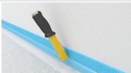
Die Befestigung des PYD®-Randdämmstreifens sollte im Bereich der Trittschalldämmung erfolgen um Schallübertragungen zu vermeiden.
