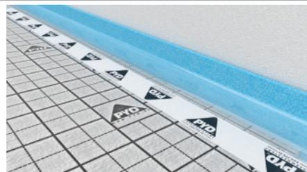
**Achtung:** Wird ein Calciumsulfatestrich eingesetzt, muss (um ein Auslaufen des Estrichwassers zu verhindern) die Folienschürze des PYD®-Randdämmstreifens spannungsfrei und vollständig mit der PYD®-Faltplatte verklebt werden.
