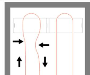
Zum Nachspannen des PYD®-Systemrohres wird dieses ca. 20 cm vor dem Bogen zusammen gedrückt und so weit über den PYD®-Umlenkbogen geschoben / gezogen bis das PYD®-Systemrohr gerade ist und auf der PYD®-Faltplatte aufliegt.
