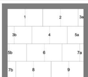
Durch intelligentes Verlegen und Zuschneiden wird eine optimale Materialausnutzung erreicht.
