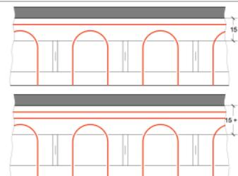
Die Umlenbleche werden mit einem Abstand von 15 cm zum aufragenden Bauteilen, gemessen von der Oberkante des Blechs gesetzt. Der Abstand ist ausreichend, um eine Zuleitung mit einem Abstand von 5 cm vorbei zu führen. Bei zwei oder mehr Zuleitungen müssen jeweils 5 cm Abstand dazu addiert werden.
