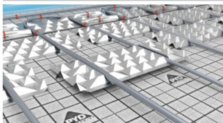
Es werden jetzt die PYD-ALU® Thermoleitbleche verlegt. Hierzu wird das PYD®-Systemrohr leicht angehoben, das PYD-ALU® Thermoleitblech darunter geschoben und das PYD®-Systemrohr in die vorgesehene Rille des PYD-ALU® Thermoleitbleches gedrückt.
