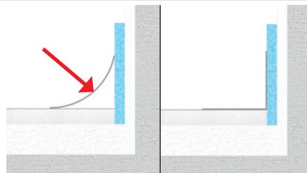
Danach wird die Folie des Randdämmstreifens auf die PYD®-Faltplatte gezogen. Die Folienschürze zeigt dabei in den Raum und sollte dabei gleich so liegen, dass später keine Spannungen auftreten.
