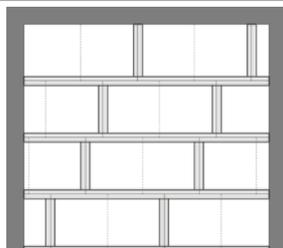
Es muss darauf geachtet werden, dass jeder Stoß verklebt wird, da sonst durch einfließendes Estrichwasser Schallbrücken entstehen können.
