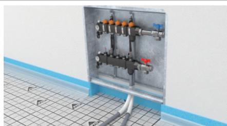
Nach dem der Raum, wie im Verlegeplan vorgesehen, mit dem PYD®-Systemrohr ausgelegt ist, wird dieses zurück zum PYD®-Heizkreisverteiler geführt, passend abgelängt, durch das PYD®-Verlegewinkelrohr geschoben...
