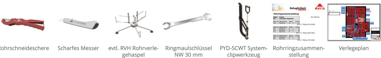
Rohrschneideschere    Scharfes Messer    evtl. RVH Rohrverlegespindel    Ringmaulschlüssel NW 30 mm    PYD-SCWT Systemclipwerkzeug    Rohrringzusammenstellung    Verlegeplan
