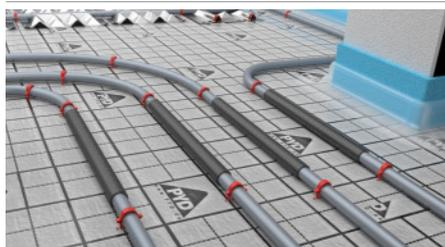
Sobald eine Zuleitung eine geplante Dehnfuge kreuzt muss ein Schutzrohr gesetzt werden.
