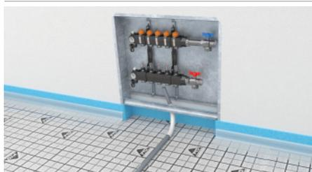
Zur spannungsfreien Anbindung des PYD®-Systemrohres an den PYD®-Heizkreisverteiler wird es durch den PYD®-Verlegewinkel geschoben und auf die exakte Länge gekürzt.
