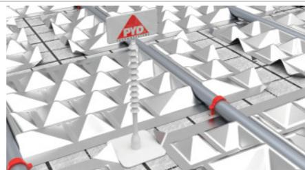
Die PYD®-EM Estrichmesstellen werden mit genug Abstand zu den Systemrohren mittig einmal pro Raum gesetzt. In größeren Räumen >50m<sup>2</sup> entsprechend mehr.
